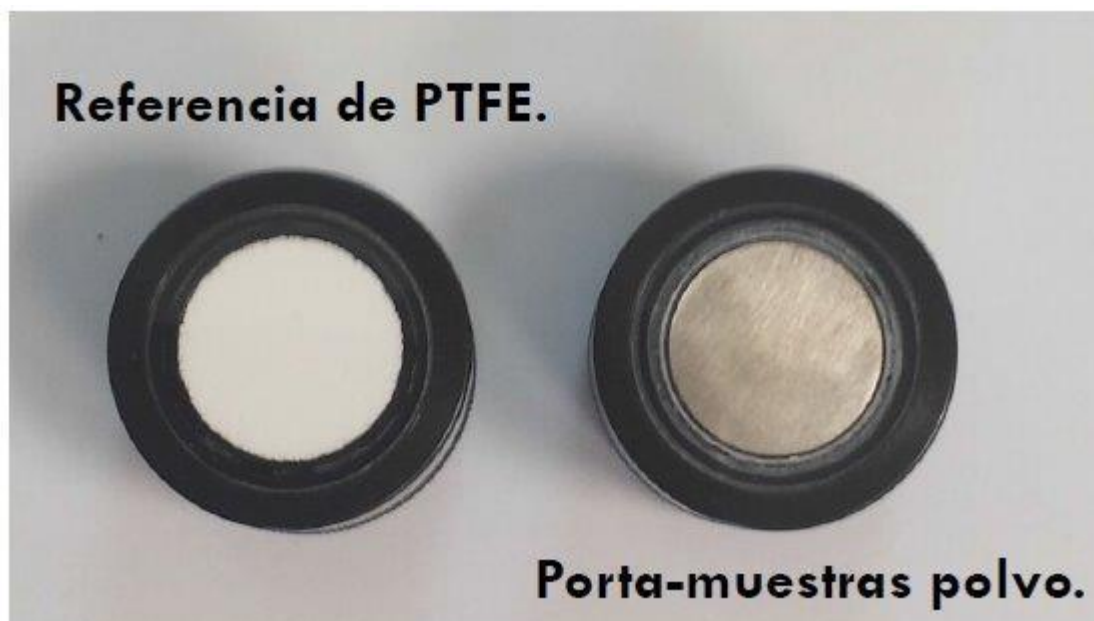
Figura 2.2. Porta-muestras y referencia usados para la obtención de espectros de reflectancia difusa.
