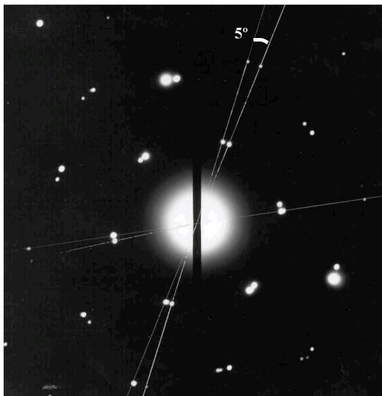
*Figura 3.7. Diagrama de difracción de dos láminas monocristalinas de hidroxiapatita natural (nt), que corresponde a una frontera de ángulo pequeño, giradas una respecto a la otra un ángulo  $\theta=5^\circ$ .*
