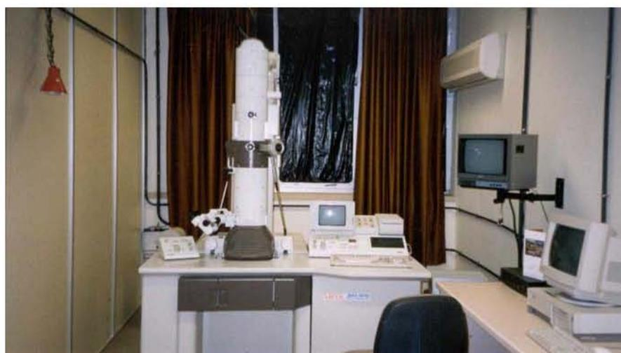
*Figura 2.8. Microscopio electrónico de transmisión marca JEOL modelo JEM 1010.*
