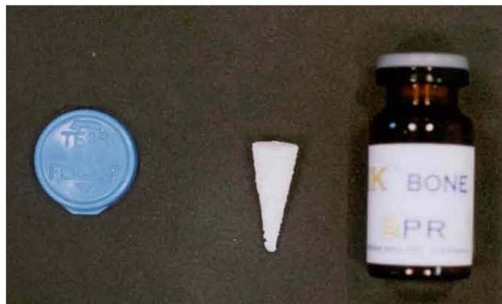
Figura 2.5. Bloque troncocónico de hidroxiapatita comercial.
