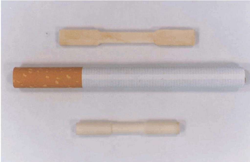
*Figura 4.1. Probetas de hueso cortical que han sido sometidas a ensayos de tracción.*
