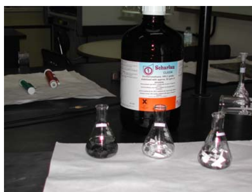
Figura III-7. Equipo (izda.) y reactivos (dcha.) para extracción de HAP.
