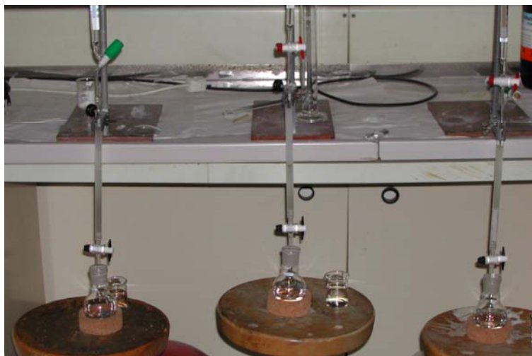
Figura III-12. Fraccionamiento del extracto en columna cromatográfica.
