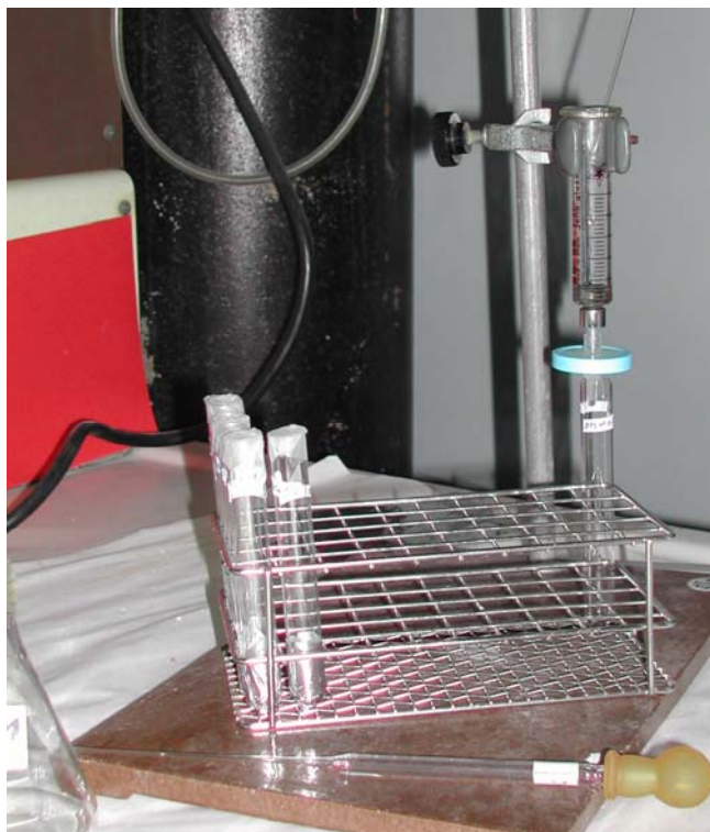
Figura III-13. Filtrado del extracto con filtro de teflón de 0,25 \mu\text{m} .
