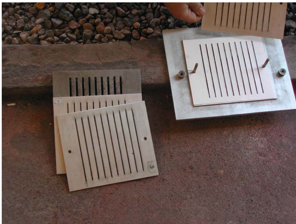
Figura III-4. Colocación de filtros (fibra de vidrio) en impactador en cascada.
