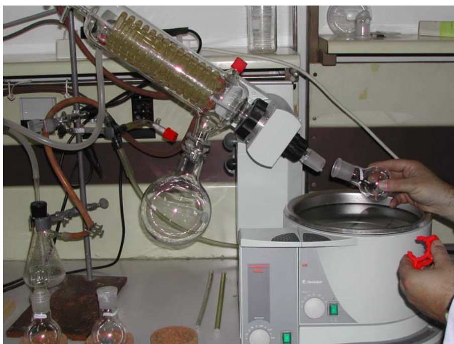
Figura III-10. Concentración del extracto mediante rotavapor.
