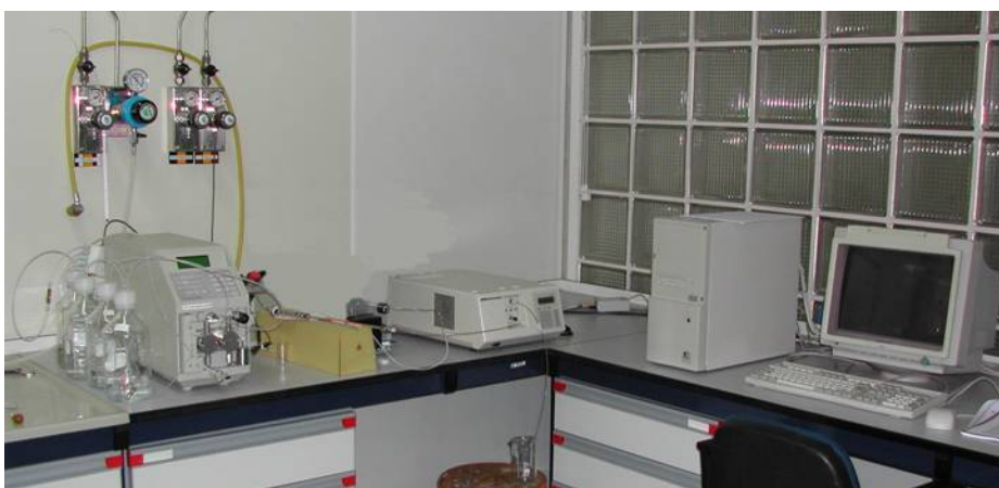
Figura III-14. Equipo para la identificación y cuantificación de los HAP.
