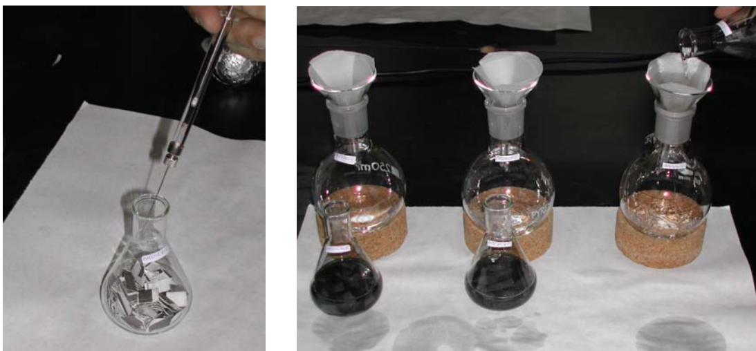
Figura III-9. Preparación del filtro para la extracción de HAP.
