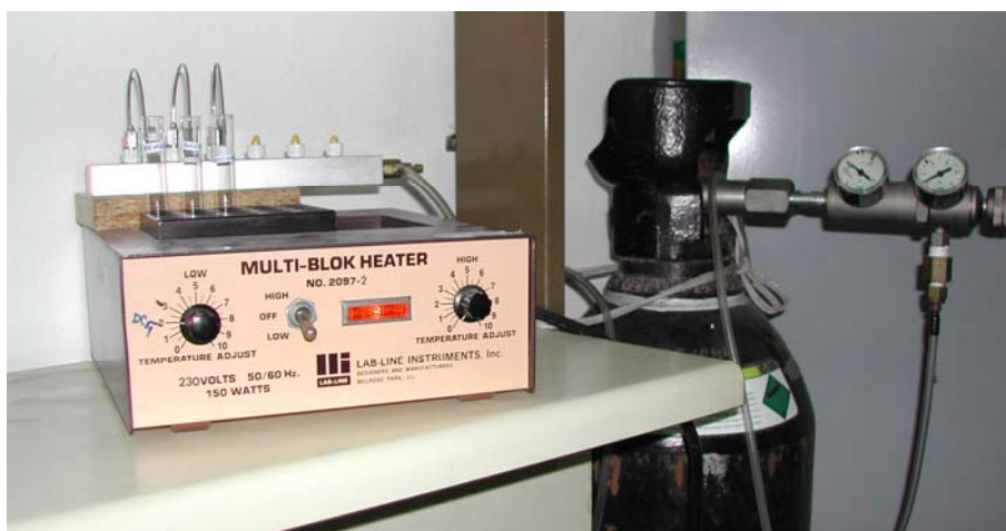
Figura III-11. Concentración del extracto en atmósfera reductora de nitrógeno.
