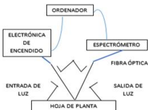
Ilustración 2: Esquema montaje detección clorofila
