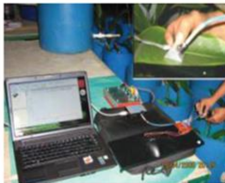
Ilustración 2: Esquema montaje detección clorofila
