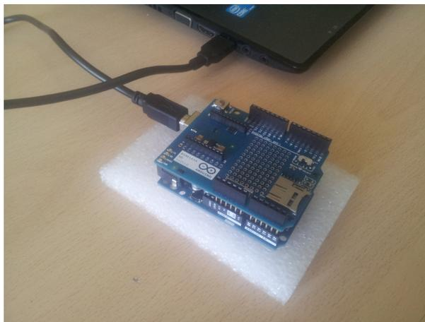
Figura 8.8: Configuración para programar la placa
