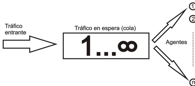
Fig. 2.3.2: Modelo Erlang-C.
