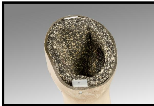
Figura 4.28 Interior de la cabeza artificial con aislamiento acústico.
