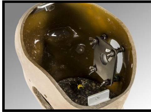
Figura 4.34 Detalle del soporte de orejas artificiales.
