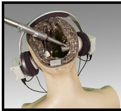
Figura 5.8 Micrófono de medida en oreja de calibración, la membrana del micrófono está en la posición del tímpano.
