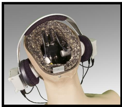
Figura 5.9 Maniquí con orejas de medida, las cápsulas electret se sitúan en la posición del tímpano.
