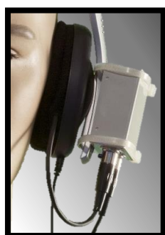
Figura 4.15 Detalle del acoplamiento entre preamplificador y auricular.
