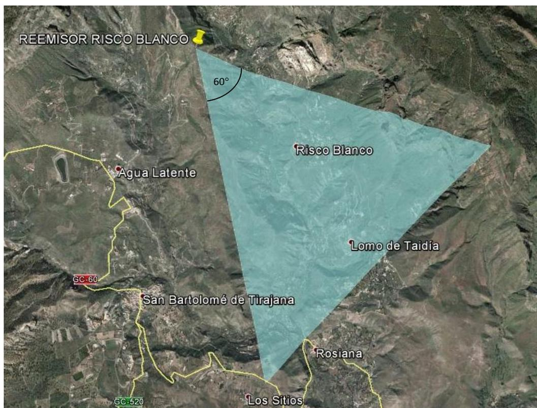
**Ilustración 34: Área de cobertura estimada que cubrirán los paneles de transmisión**
