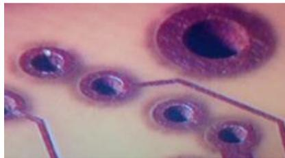
**Figura 98. Resultado del proceso de metalización**
