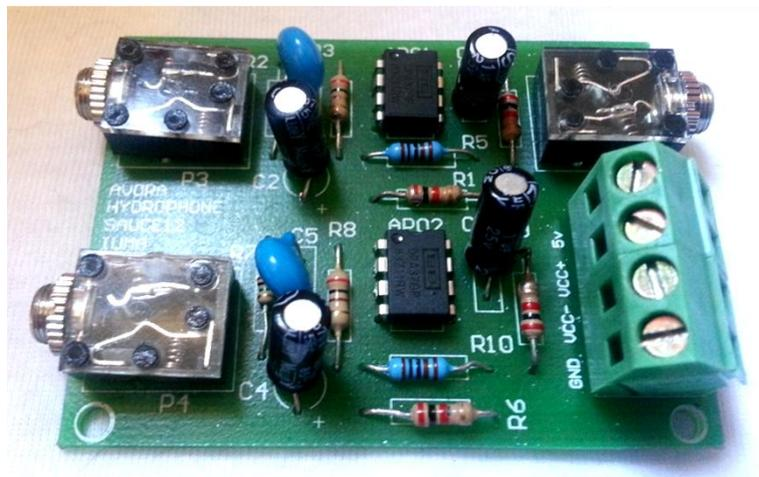
Figura 51. PCB preamplificador de hidrófonos
