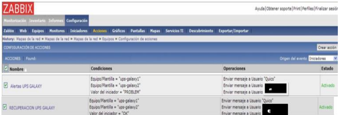
Figura 4.53 Configuración acciones para el caso de las SAIs del CPD-I
