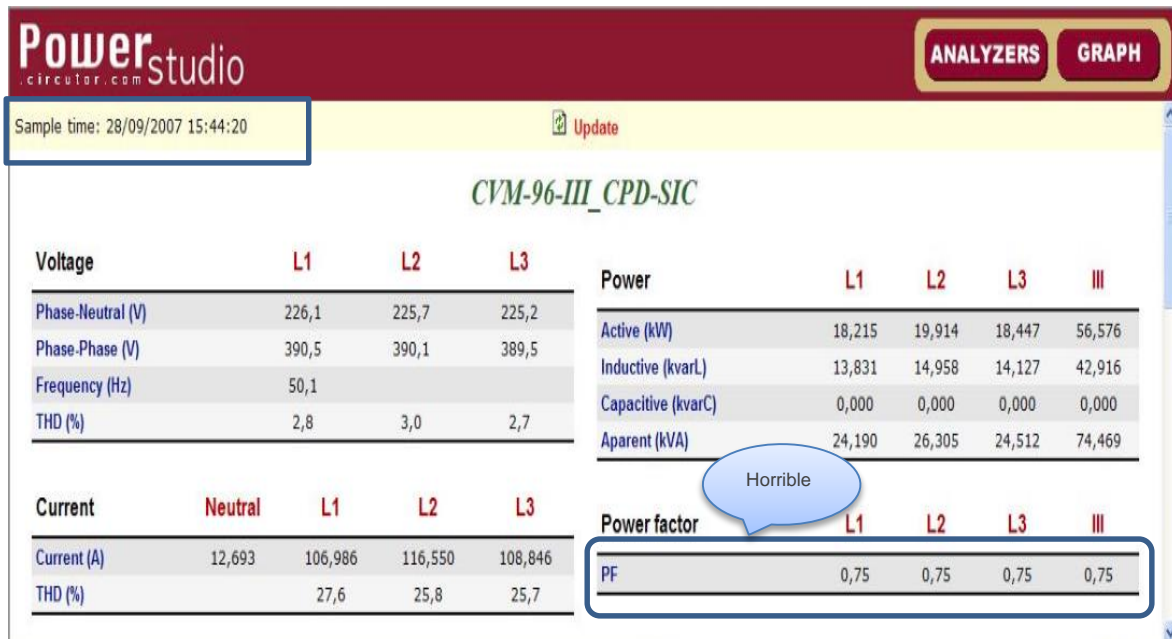
Figura 7.2 Captura del programa de adquisición de datos eléctricos 2 .
