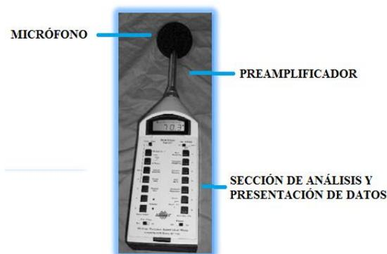
Figura 10.1- Estructura general de un sonómetro.
