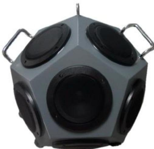
Figura 10.8.- Altavoz omnidireccional BP012.
