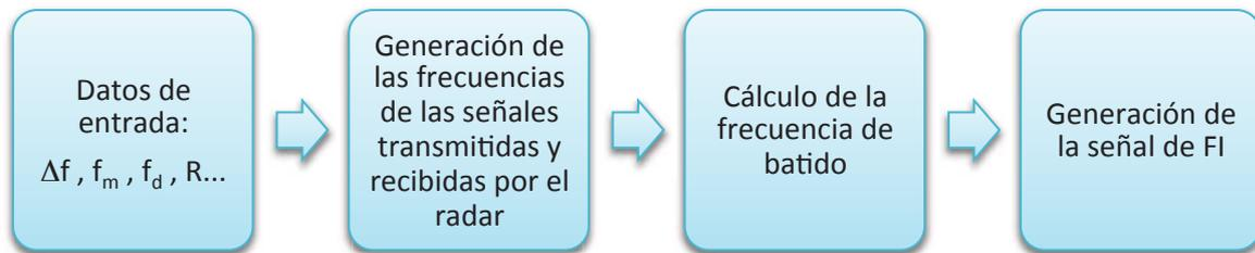
Figura 2 – Proceso para obtener la señal de FI
