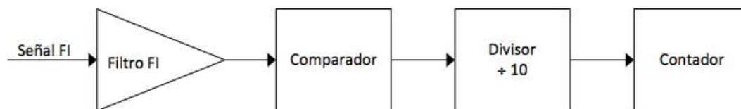
Figura 29 – Amplificador-filtro FI, comparador, divisor y contador del sensor CW-FM
