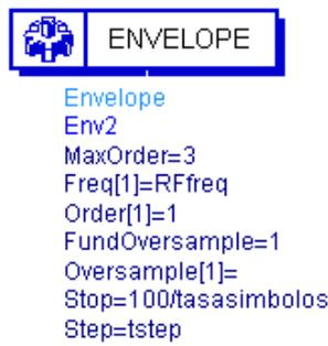
**Figura 7.4:** Configuración de la simulación de envolvente
