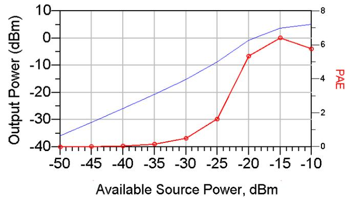
**Figura 6.23:** Gráfica con valores de PAE y las potencias de salida con la que se obtienen
