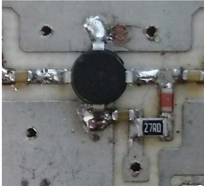
Figura 99. Fotografía del amplificador MAV-11BSM+
