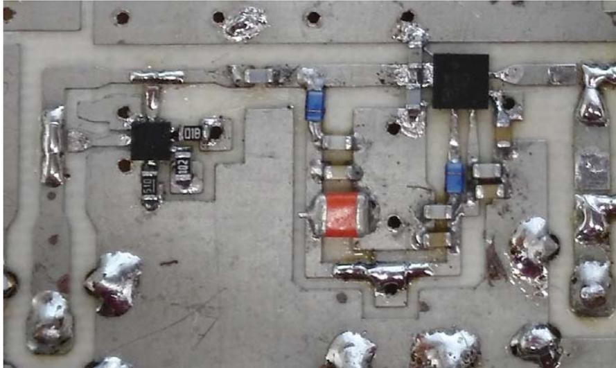
Figura 143. Vista del conmutador JSW2-63DR+ junto al amplificador de potencia
