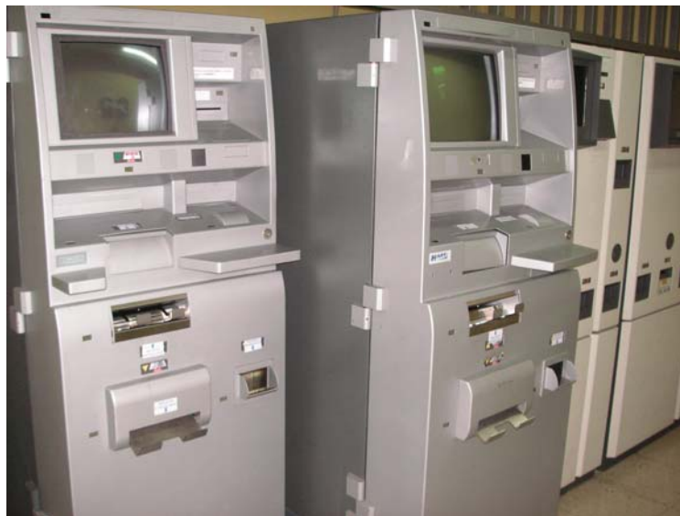
Figura 41: Cajero de autoliquidación. Dispositivos que se encuentran en los puntos de confluencia para que los conductores depositen el dinero obtenido durante la prestación de su servicio. La ventaja de estos dispositivos es que el dinero se encuentra en manos de los empleados el menor tiempo posible evitando riesgos de pérdidas o robos.
