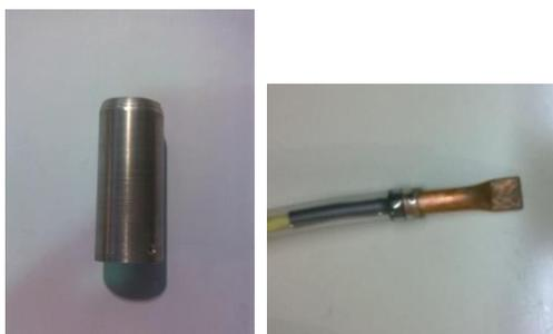
Figura 2. Electrodos: cátodo y ánodo.
