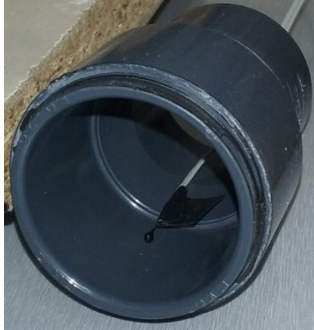
Figura 3. Termistor NTC para la medición de la temperatura ambiente.
