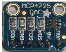
Figura 3. Convertidor analógico-digital **MCP4725**.
