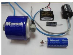
Figura 8. Fotografía de los supercondensadores utilizados.
