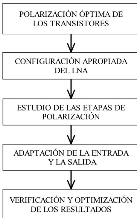
**Figura 4.9** Flujo de diseño del LNA.
