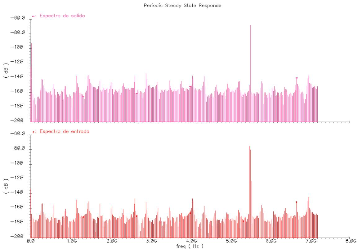
Figura 5.67. Respuesta espectral del mezclador
