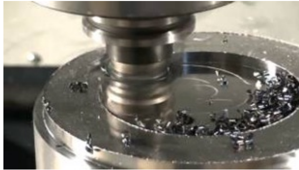
Ilustración 4. Fabricación sustractiva. Arranque de material con fresadora (Fuente: bacedores.com)
