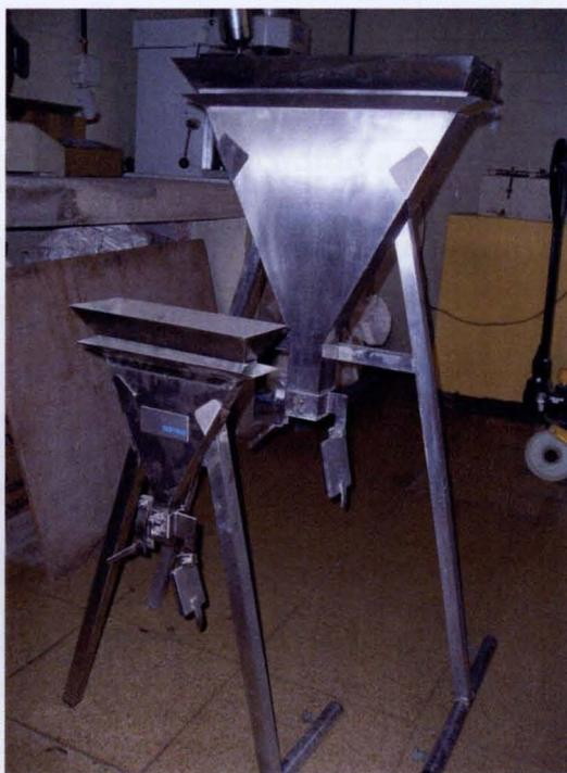
**Embudo para mortero y embudo para hormigón**
