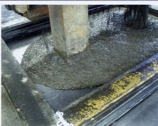
Hormigón Autocompactante fluyendo -
