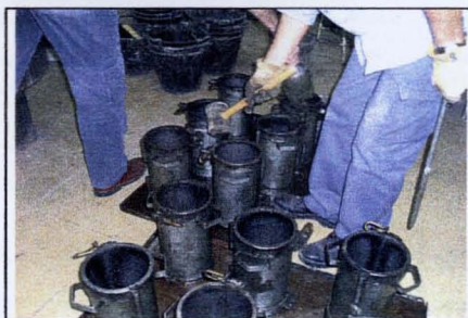
Foto: proceso de compactado de probetas
