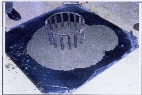
Foto: Asentamiento en Anillo J con segregación en un borde
