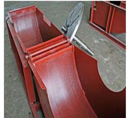
Ilustración 4.5. Astilladora Mixta
