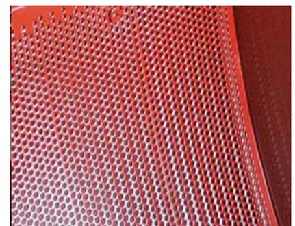
Ilustración 4.6. Malla de Astilladora Mixta
