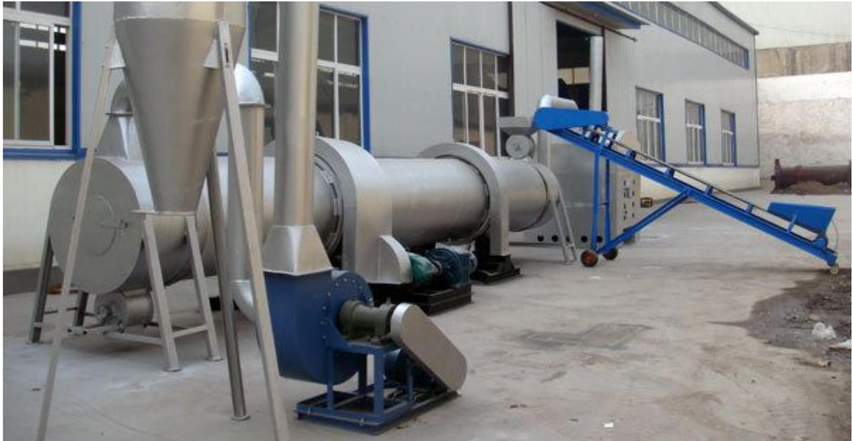
**Ilustración 4.10. Secadora Rotativa**
