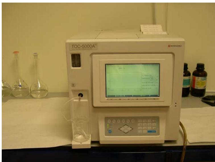
**Figura 3.4** Analizador de carbono orgánico total (Shimadzu TOC-5000A).
