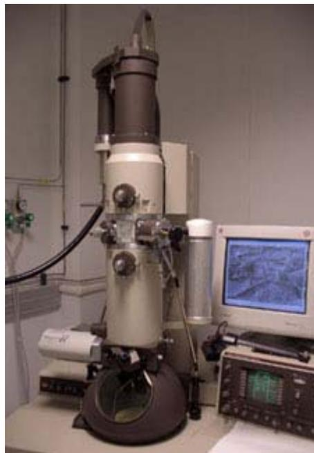
**Figura 3.8.** Microscopio de Transmisión Electrónica
