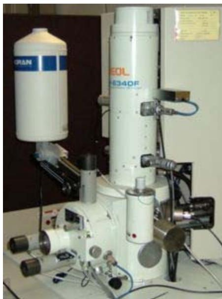
**Figura 3.9** Microscopio de Barrido Electrónico
