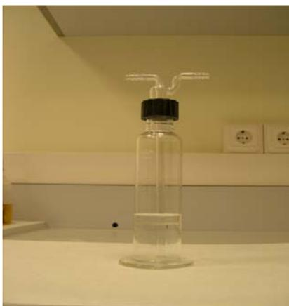
**Figura 3.1:** reactor fotocatalítico
