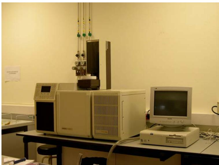
**Figura 3.5b** Cromatógrafo de gases masas (Varian Saturn 2000 GC/MS/MS ).
