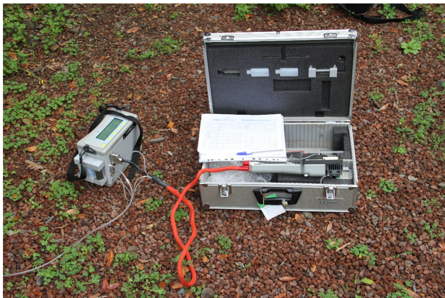
Foto.2.10.- Analizador de gases por infrarrojo (IRGA), sistema abierto de la marca LCPro (ADC Bioscientific, 2004).
