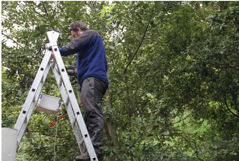
Foto 2.12.- Medición sobre escalera con el LCPro de hojas del tercio superior de la copa de un Laurel en los Tilos de Moya.
