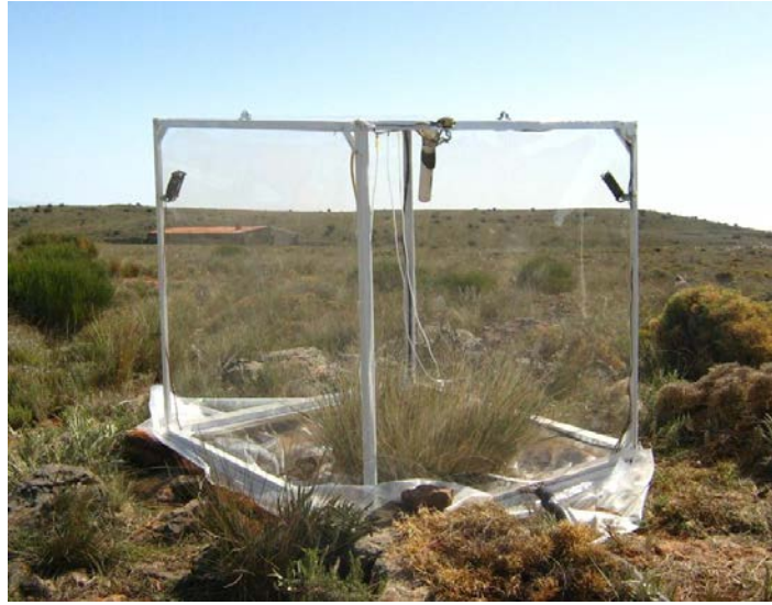
Foto 1.- Cámara de cierre transitorio. (Ballesteros, A.L., 2013).
