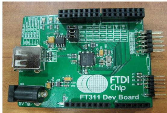
**Figura 22. Tarjeta DS-UMFT311EV de FTDI Chip.**
