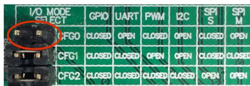
Figura 38. Configuración jumpers de la tarjeta FTDI Chip DS-UMFT311EV.
