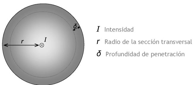
**Figura 1.3 Efecto pelicular en un conductor de sección circular.**
