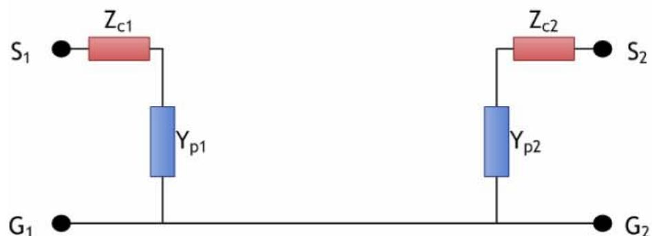
**Figura 2.12 Modelo de impedancias de la estructura *open*.**
