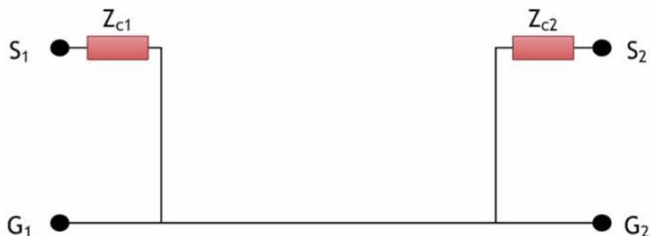
**Figura 2.10** Modelo de impedancias de la estructura *short*.
