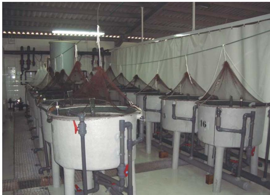
**Figura 5. Imagen de los tanques de 200 l del circuito B con el tanque de percolación al fondo.**
