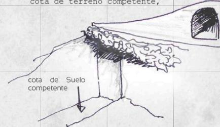
2- Colocación de listones bajo el aplacado de mampostería, apoyados en puntales metálicos, que no tendrán función estructural, ya que el muro es autoportante. Se realizará mediante batache A2 2m
