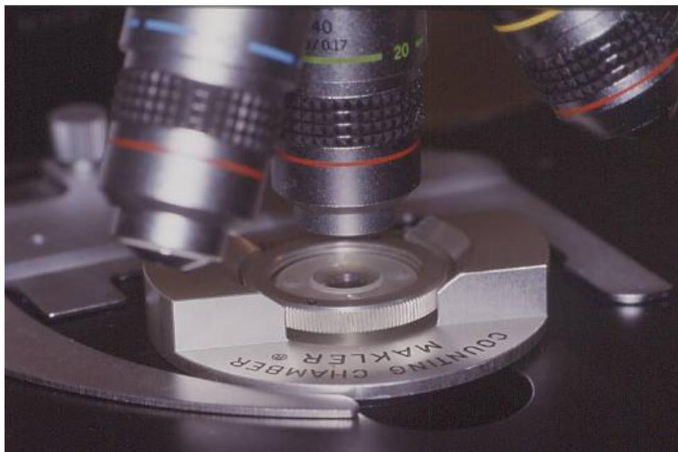
*Fig. 22. Cámara de Makler en la Platina del Microscopio de Contraste de Fases*
