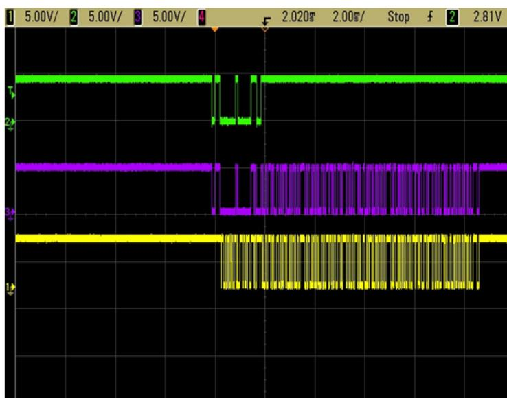
**Figura 5.26.** Señal transmitida y recibida en el sistema de comunicaciones óptica de visible y la respuesta del microcontrolador. Canal 2, señal transmitida. Canal 3, señal recibida en el receptor óptico. Canal 1, trama de respuesta
