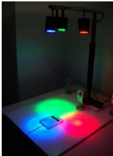
**Figura 2.7.** Sistema VLC con receptor basado en CCD. Usado en redes de sensores.
