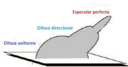
**Figura 3.5.** El fenómeno de reflexión de la luz visto desde sus tres componentes: difusa uniforme, difusa direccional y especular
