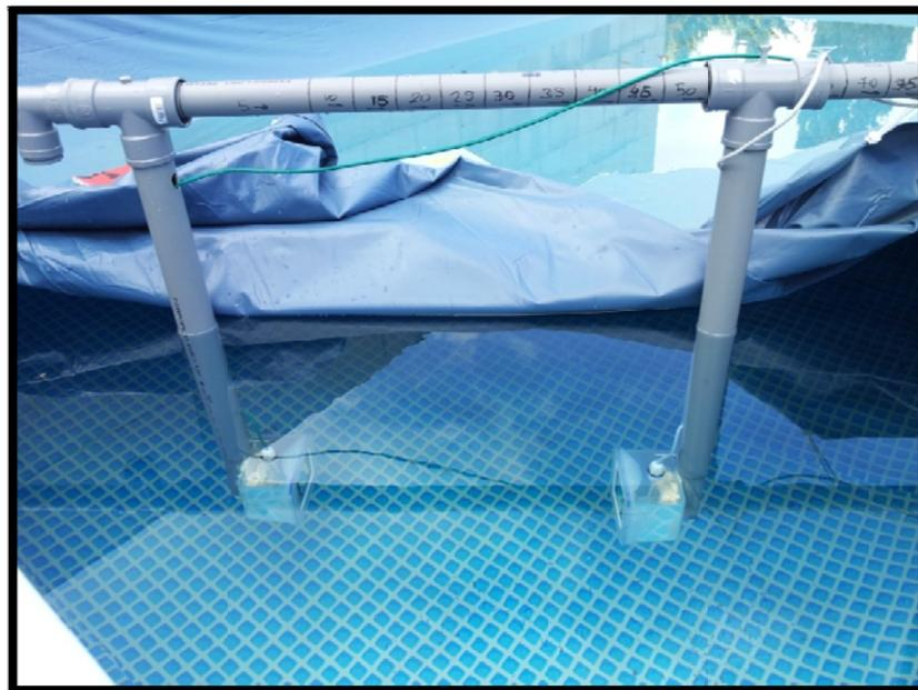
**Figura 7.1** Estructura para pruebas de comunicaciones submarinas VLC en piscina
