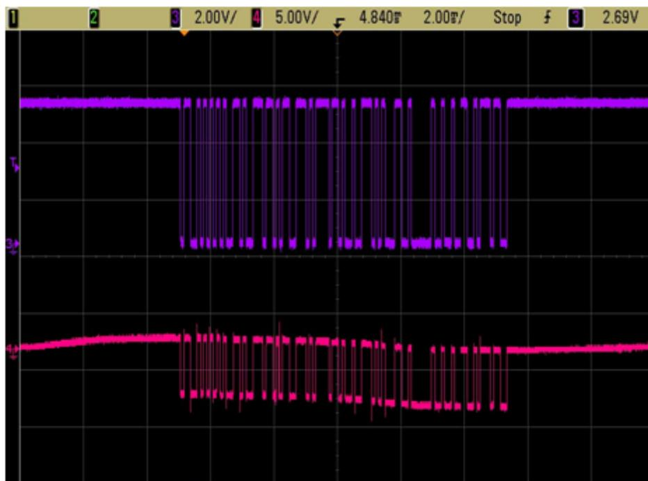
**Figura 5.27.** Señal transmitida y recibida en el sistema de comunicaciones ópticas de infrarrojo. Canal 3, señal transmitida y Canal 4, señal recibida.
