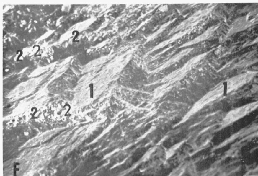
Fig. 23.—(x500). 1: Marcas en escalera de tipo geomórfico.—2: Calcificación de relleno, después de una fase de lixiviado de la sílice por una epigenesis parcial del cuarzo por la dolomía y posteriormente la calcita
