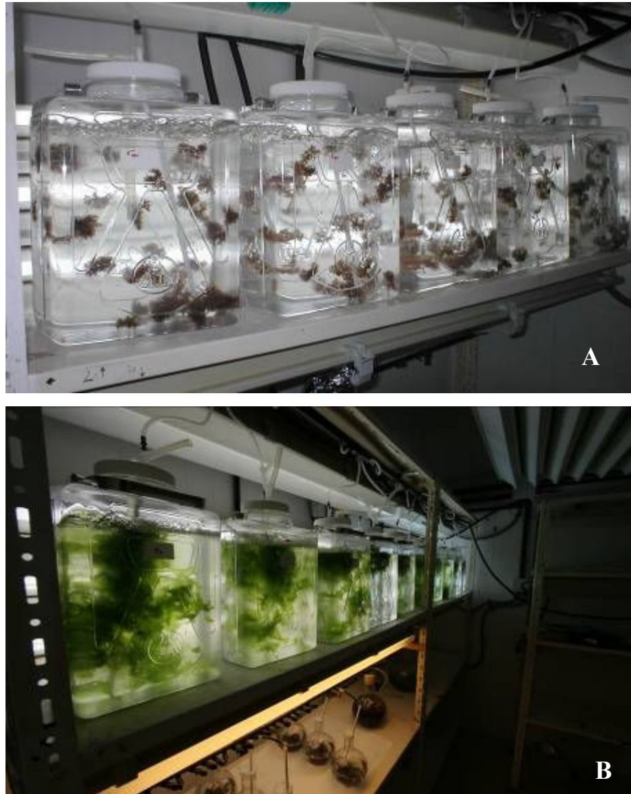
Figura 4.- Sistema de cultivo empleado para los experimentos a escala de laboratorio bajo condiciones controladas con Gracilaria cornea (A) y Ulva rigida (B).
