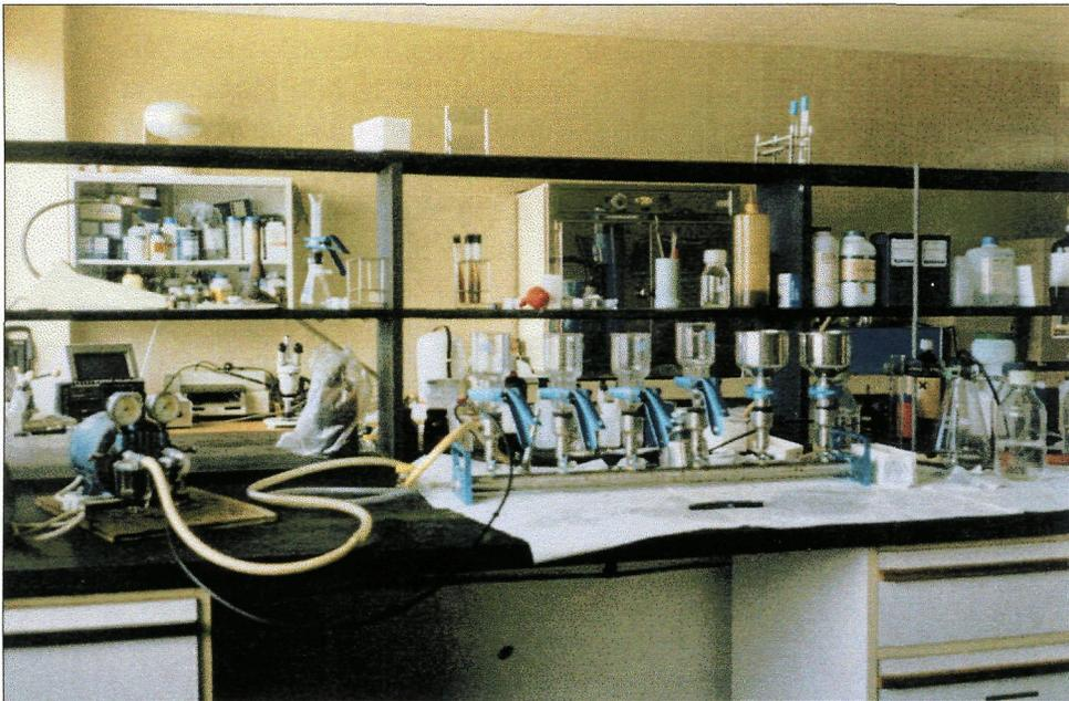
Equipo de filtración, preparado para su utilización, con los embudos de filtración (de vidrio o de acero inoxidable) y una bomba de vacío (a la izquierda). En la imagen, una batería de seis elementos lo que permite mayor rapidez a la hora de analizar varias muestras al mismo tiempo.
