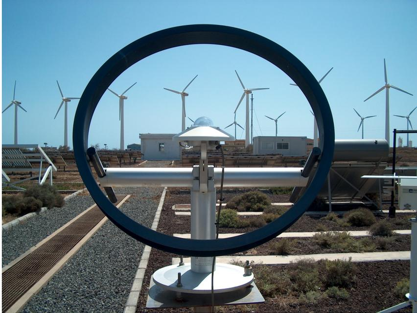
Figura 2.11: Piranómetro con anillo de sombra para eliminar la radiación directa. Cortesía del ITC
