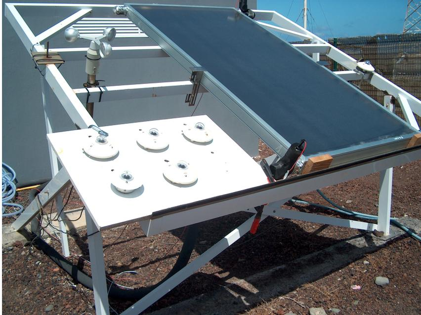
Figura 2.10: Piranómetros Kipp & Zonnen. Cortesía del ITC
