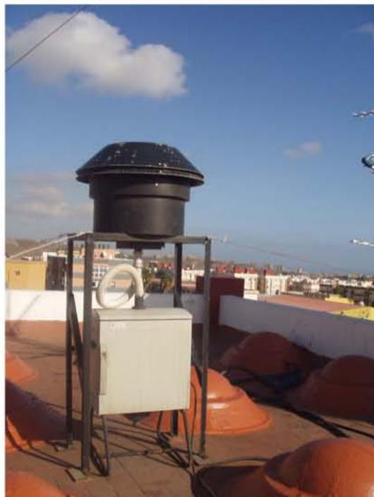
**Figura III. 4.- Captador de alto volumen equipado con cabezal PM10 ubicado en Casa de la Cultura**
