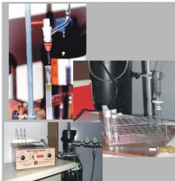
**Figura III. 9.- Procesos durante la separación de la fracción de HAP.**
