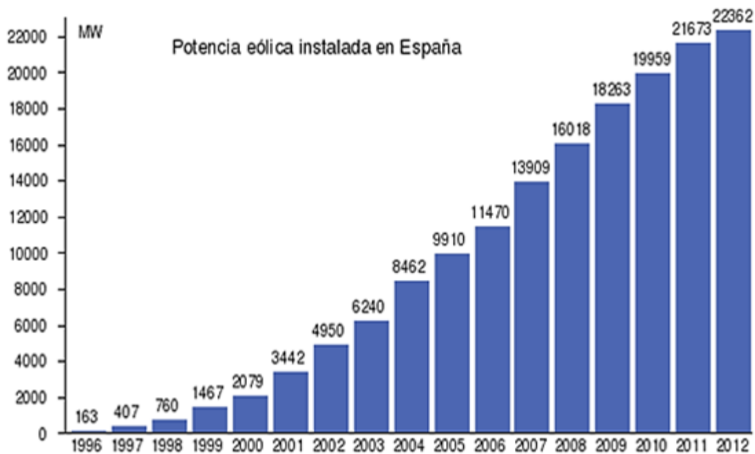
Figura 1.2.1: Potencia eólica instalada a lo largo de los años, datos Red Eléctrica Española.
