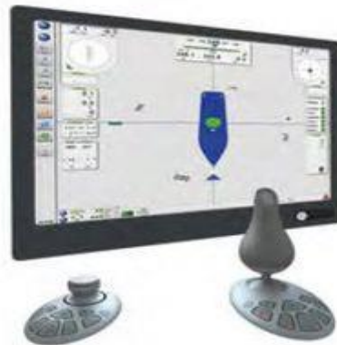
Figura 4.2.1: Joystick e interfaz para el control manual del sistema DP.
