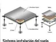
Sistema instalación del suelo. Mantenimiento de instalaciones sin obras
