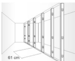
Rastreles guías metálicas verticales.
