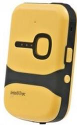
Es de gran utilidad para el seguimiento de personas. Está compuesto de una carcasa impermeable que garantiza que no sufra daños de fuentes externas, teniendo una batería interna que proporciona una conexión constante durante días, mientras que también rastrea los cambios de movimiento y altura.
