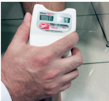
Figura 18a. Medición de fuerza del cuádriceps con MicroFet3.
