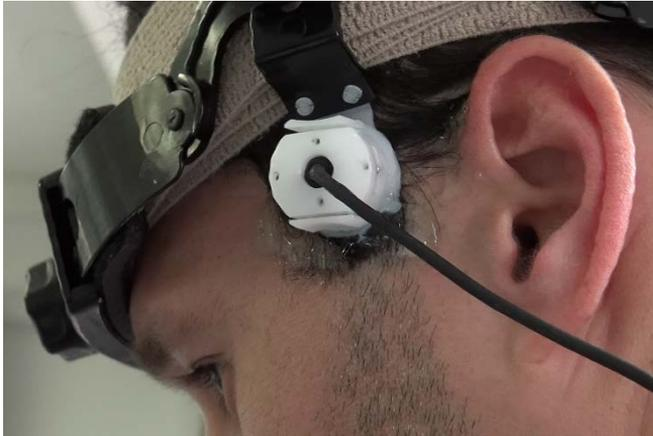
*Figura 5: Transductor Doppler con casco en la ventana transtemporal. ACM izquierda.*
