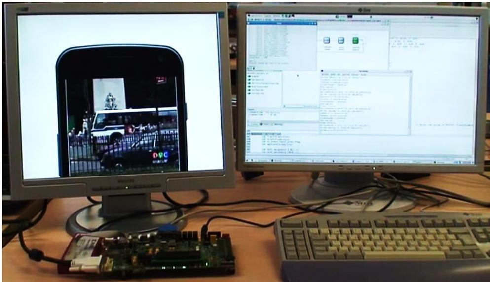
Figura 99. Prototipo del sistema funcionando en una placa Xilinx ML507
