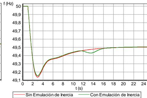
(d) - Supuesto 2 - Desconexión generadores en Las Salinas
