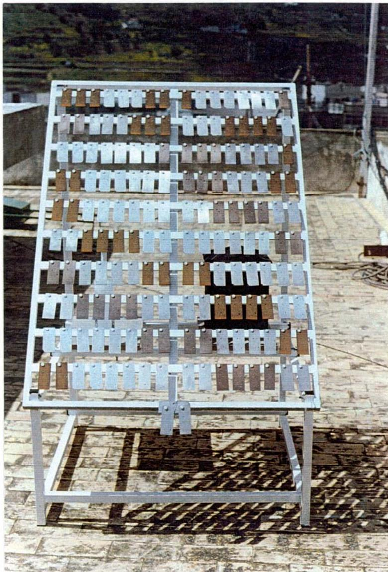
**Figura 3.4:** Vista frontal de la estructura metálica y de las probetas objeto de estudio.
