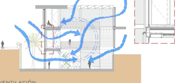
EN ESTE ESQUEMA SE APRECIA COMO EL LUCERNARIO Y LA CELOSÍA FRENA RADIACIÓN DIRECTA AL MEDIODÍA EN VERANO, A UNA HORA DE RADIACIÓN MÁS SUAVE, O EN INVIERNO, LA LUZ SOLAR PENETRA EL EDIFICIO SIN IMPEDIMENTOS.
