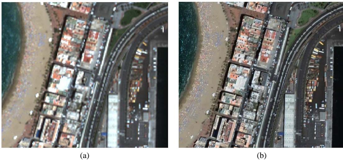
Figura 2.4. Composición en color a partir de las bandas del satélite Quickbird: (a) imagen multiespectral original, y, (b) imagen tras la aplicación de técnicas de *pansharpening*.
