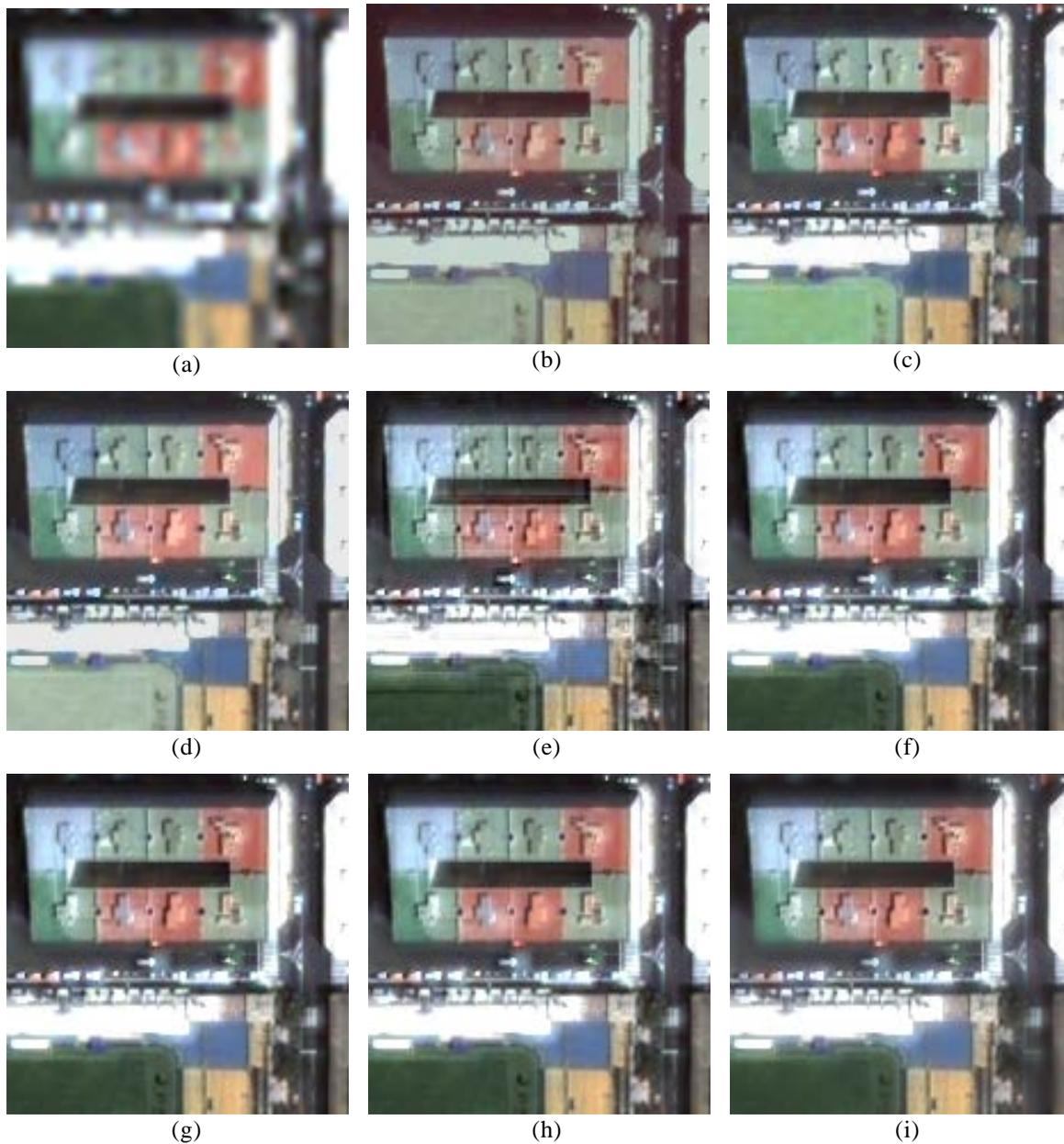
Figura 2.13. Ejemplo de algoritmos de fusión: (a) composición RGB original, (b) Brovey, (c) PCA, (d) IHS, (e) eIHS, (e) Mallat (TWD), (f) À trous, (g) À trous-PCA, (h) À trous-IHS e (i) À trous-DF.
