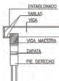
EL APOYO DE LAS VIGAS EN LA VIGA MAESTRA SE RESUELVE MEDIANTE UN ENCAJONADO
