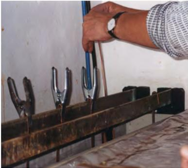
Pinzas metálicas para mantener el contacto de la plancha con el polo positivo
