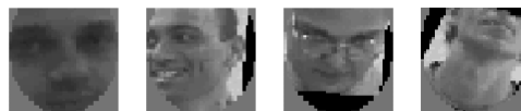
Figura 2. Ejemplos de fallos de los procesos de detección y normalización de las caras con el sistema descrito en la Sección 2.
