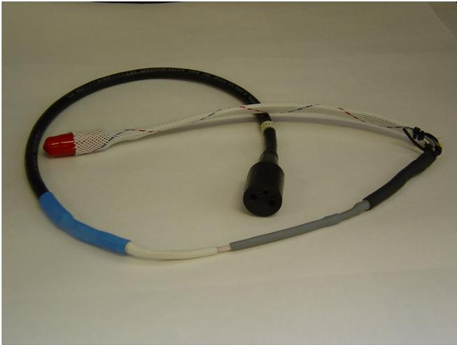
Figura 6. Detalle de la membrana utilizada en el sensor de hidrocarburos y unión al conector exterior.
