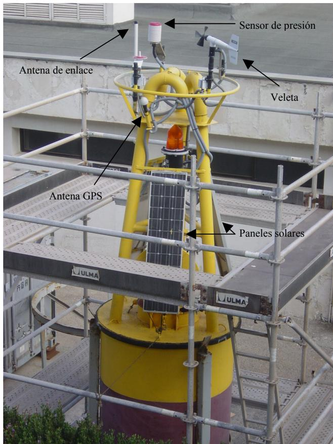
Figura 4. Segundo diseño de boya de forma cilíndrica. Los paneles solares son más alargados manteniéndose la superficie útil del primer diseño. Además, se observa el montaje sobre los andamios de instalación y mantenimiento.
