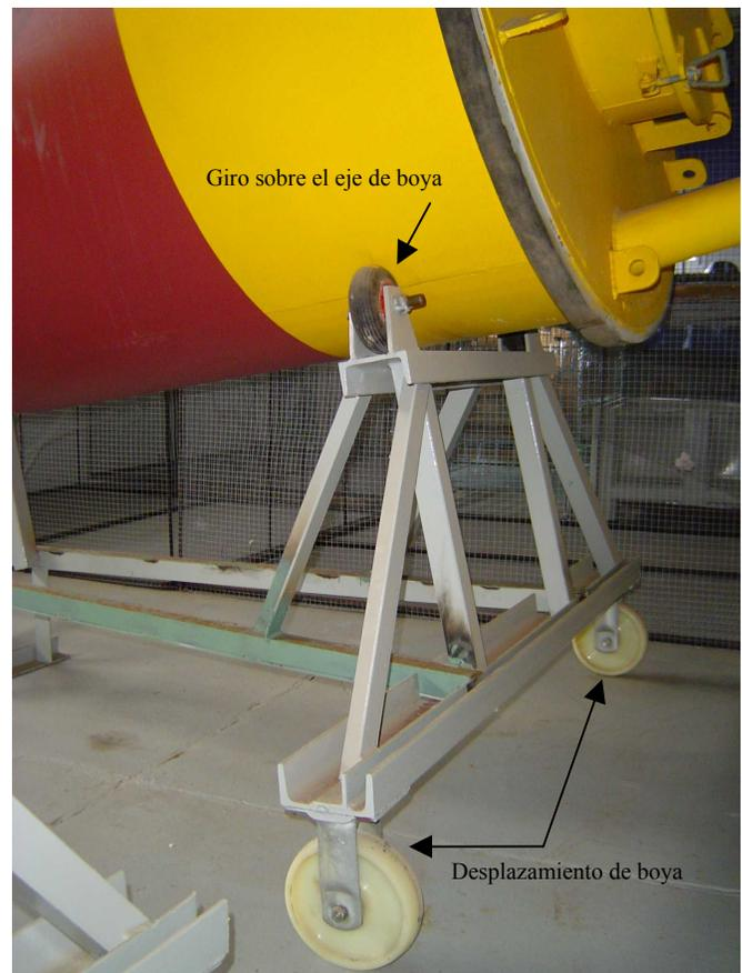
Figura 5. Boya basada en el segundo diseño con el armazón utilizado para el montaje y mantenimiento. Resulta mucho más seguro para el operario y la ubicación de las ruedas permite a un sólo operario mover toda la estructura con facilidad.
