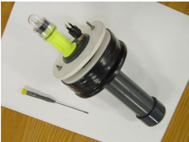
Figura 7. Aspecto del sensor una vez integrado. El cilindro plástico inferior contiene la parte acondicionadora de la señal. En la parte superior se conectaría la membrana.
