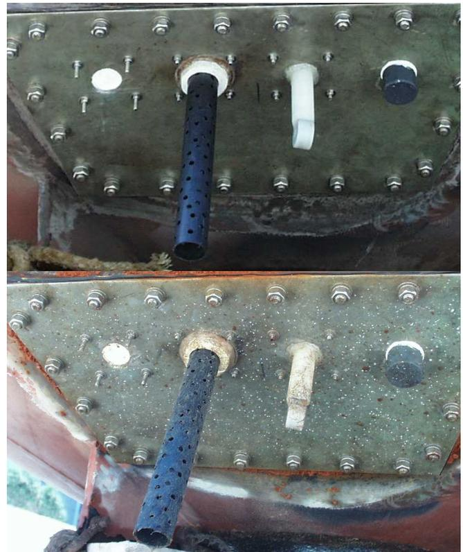
Figura 3. Aspecto que presentan los sensores después de 1 mes de exposición al mar. De izquierda a derecha se encuentra el sensor de temperatura y conductividad.
